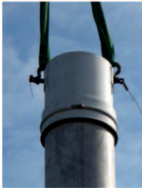
Tête de levage pour colonne jusqu'à 60 mètres
